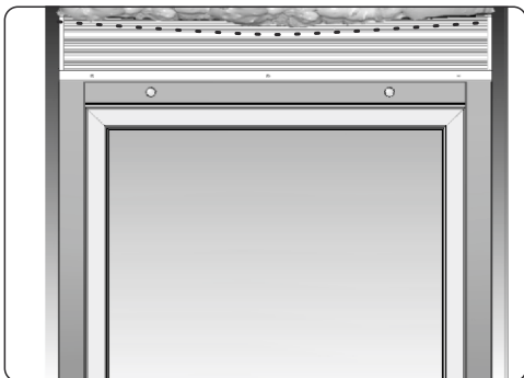
- ugięcie górnego profilu skrzynki .
